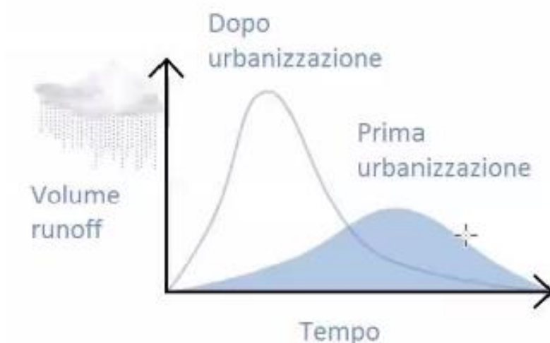
Figura 5.12 Idrogramma che simula la risposta idrologica di un bacino a seconda del livello di urbanizzazione
