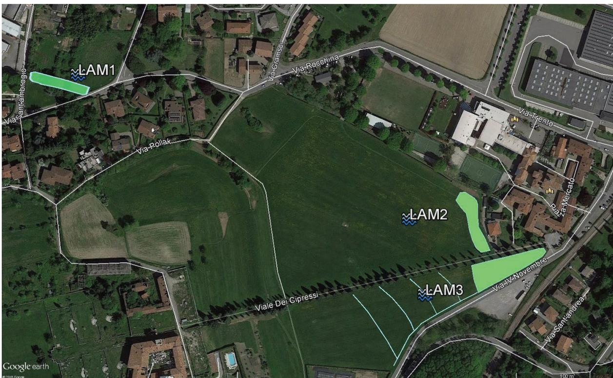
Individuazione delle tre aree di laminazione (LAM1, LAM2, LAM3) in cui creare delle depressioni morfologiche inerbite (zone a prato non coltivabili) da destinare alla laminazione di eventi di piena significativi e/o alla infiltrazione nel sottosuolo delle acque meteoriche
