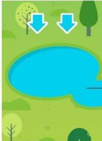
*Vasche di accumulo ricreate in aree fruite in superficie inerbite e con forme più naturalistiche, come parchi. L'allagamento è controllato ed in sicurezza, con altezze massime tipicamente di 30-50 cm e previste ogni 5-10 anni. Sono asciutti quando non piove.*
