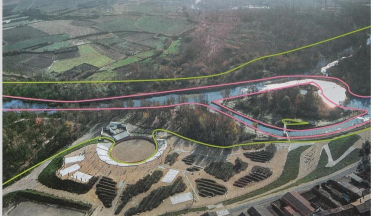
L'intervento riguarda la realizzazione di un parco fluviale a margine dell'abitato di superficie totale pari a 168.000m<sup>2</sup>. Il progetto ha previsto la possibilità di allagamento di tutta l'area golenale, compresa l'arena di 6000 posti che aggiunge volume alla capacità di invaso. Il progetto integra perfettamente aspetti idraulici, fruitivi ed ecologici.
